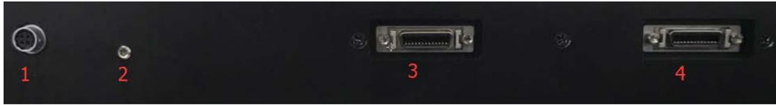
1: 电源输入接口, DC+24V; 2: 机壳接地孔
