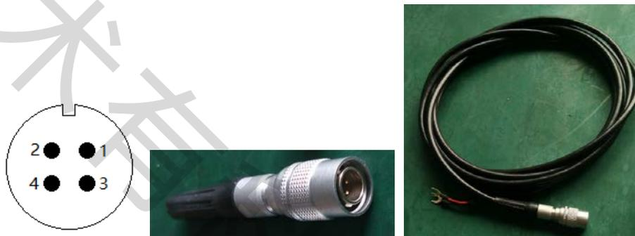
图 4-3 相机直流电源接口
